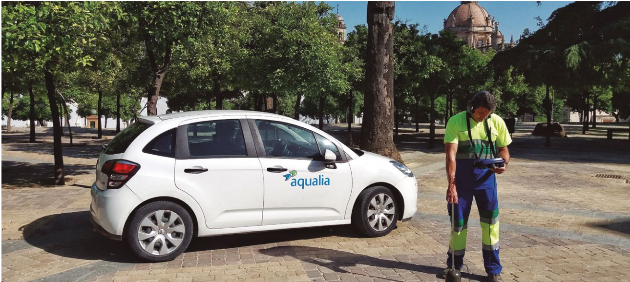
Busqueda de fugas en Jerez de la Frontera, Cádiz, España.
